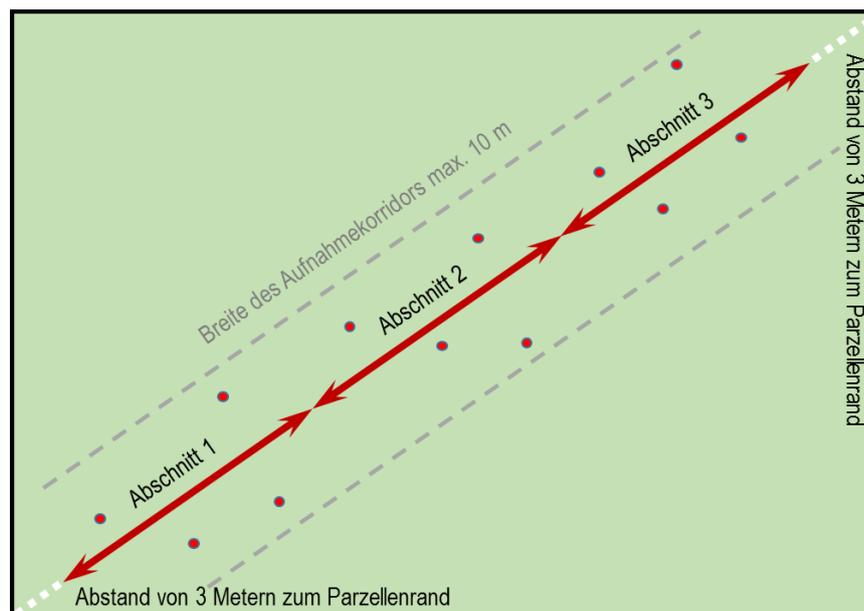
Abbildung 5 - Richtig: Verteilung von 12 Fotos von Kennarten auf dem Schlag entlang von Diagonalen, die durch den Schlag verlaufen (Transectverfahren)
